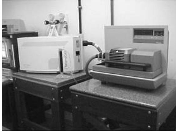
**Figura 17** - Equipamento de TGA, modelo TA Instruments Systems DSC 2910.
