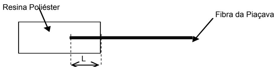
**Figura 22** – Esquema do corpo de prova utilizado no ensaio de pull out, onde  $L$  (comprimento do embutimento) variou de 5 a 40 mm.
