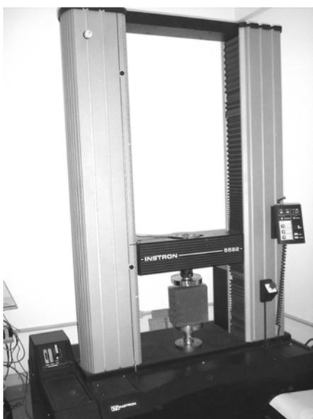
**Figura 26** – Máquina de ensaios Instron, modelo 5582.
