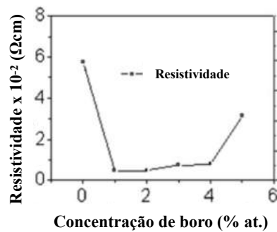
Figura 25. Variação da resistividade elétrica com a concentração de boro em % at. em filmes à base de ZnO (Adaptado de PAWAR et al. , 2009).
