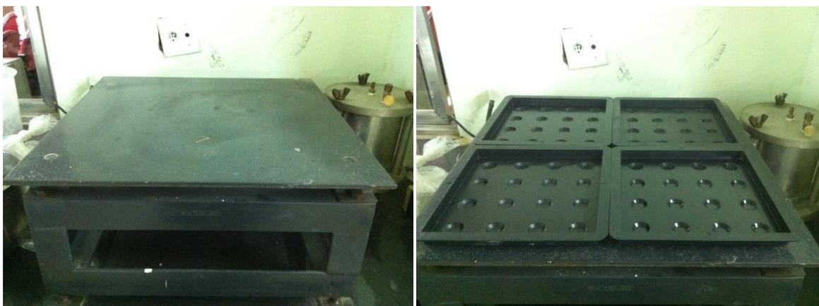
**Figura 4.25 – Equipamentos utilizados na fabricação do ladrilho hidráulico piso tátil.**
