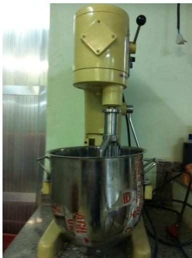
**Figura 4.24 – Equipamento utilizado na mistura dos materiais para produção do ladrilho hidráulico piso tátil.**
