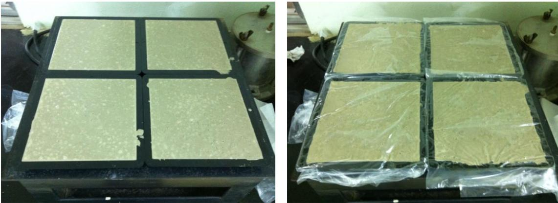
**Figura 4.26 – Moldagem dos ladrilhos hidráulicos.**
