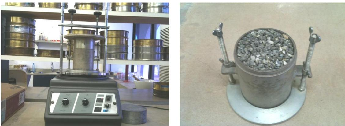
**Figura 4.12 – Aparato experimental para determinação da máxima densidade seca aparente.**
