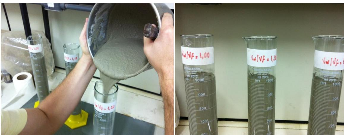
**Figura 5.17 – Análise da exsudação nas argamassas produzidas com adição do RBRO.**
