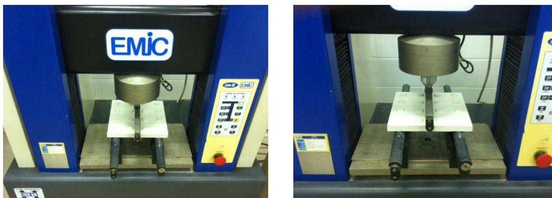
**Figura 4.29 – Ensaio de determinação do módulo de resistência à flexão dos pisos produzidos.**
