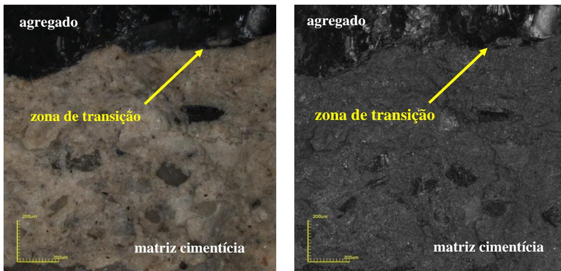
Figura 5.23 – Imagem do concreto, zona de transição, ampliação 216x.
