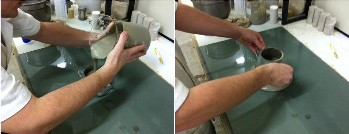
Figura 4.16 – Ensaio de espalhamento das argamassas.
