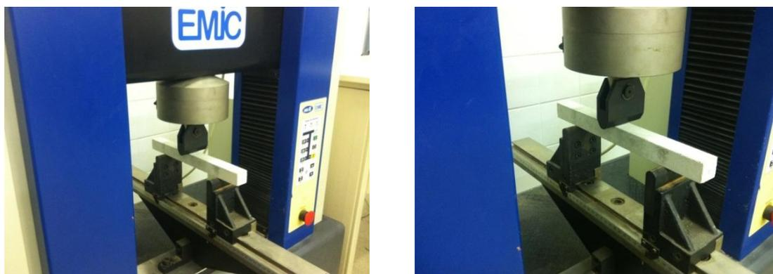
**Figura 4.21 – Ensaio de resistência à flexão dos corpos-de-prova.**
