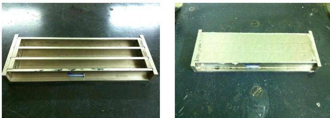
**Figura 4.19 – Moldagem dos corpos-de-prova prismáticos.**
