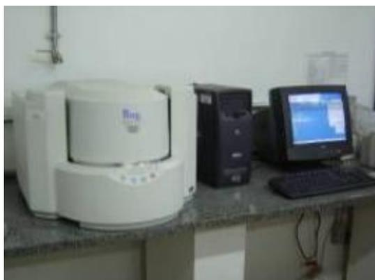
**Figura 4.4 – Shimadzu EDX-700 instalado no LECIV/UENF.**
