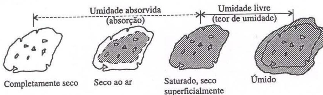
**Figura 3.2 – Representação esquemática da umidade do agregado (Neville, 1997).**
