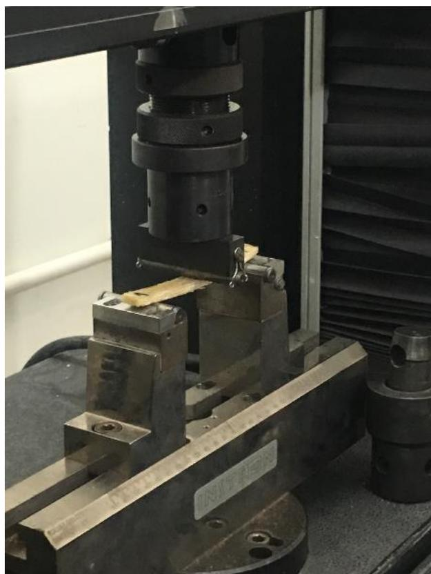
**Figura 25 - Ensaio de Flexão sendo executado**
