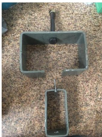
**Figura 26 - Material desenvolvido para execução do ensaio de tração perpendicular**
