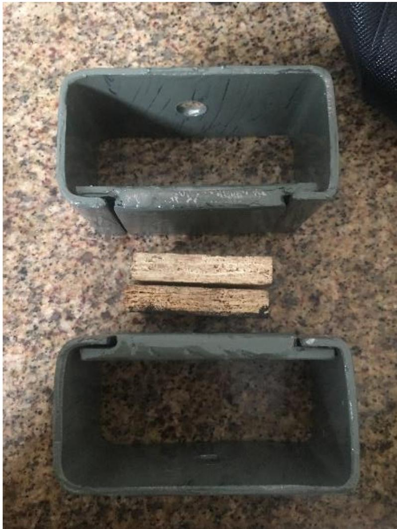
**Figura 28 - Material desenvolvido para execução do ensaio de arrancamento de parafuso**
