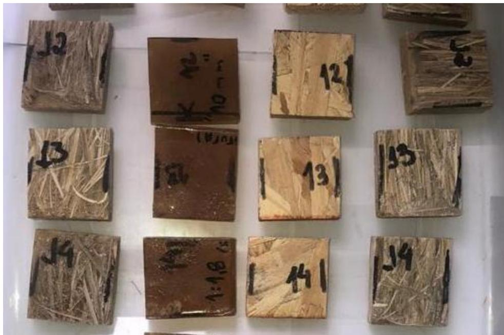
Figura 23 - Corpos de provas para os ensaios físicos
