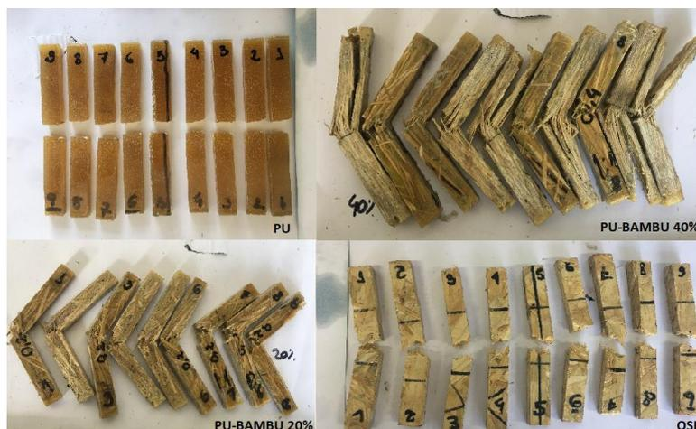
**Figura 40 - Corpos de prova após o ensaio de impacto**
