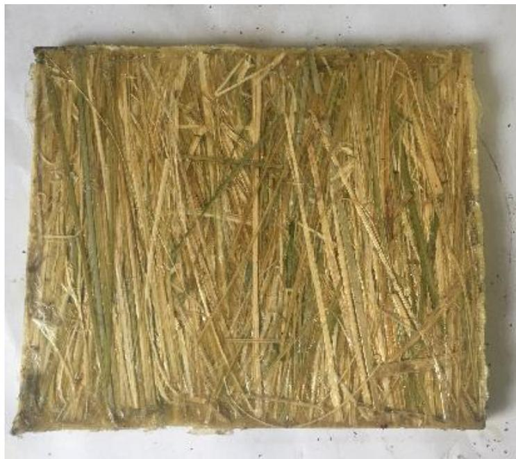
**Figura 22 - Preparação dos corpos de prova: Material prensado**
