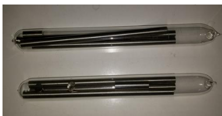
Figura 35 - Corpos de prova da liga Ti-6Al-4V encapsulados em tubo de quartzo em atmosfera de argônio (Fonte: O autor).
