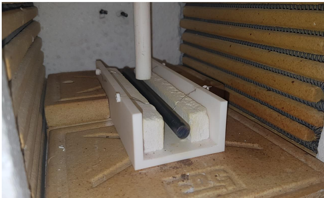
Figura 38 – Detalhe do suporte no interior do forno para medição de propriedades elásticas em função da temperatura, a altas temperaturas, através da técnica de excitação por impulso (Fonte: O autor).
