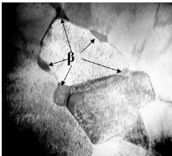
Figura 16 - Microscopia eletrônica de transmissão, com aumento de 12.000x, da microestrutura da liga Ti-6Al-4V recozida revelando a predileção da fase \beta de ocupar os contornos de grãos da fase \alpha (Fonte: Couto et al., 2006).
