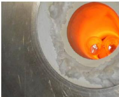
Figura 11 - Corpos de prova de liga de titânio encapsulados durante tratamento térmico (Fonte: Cortez et al, 2007).
