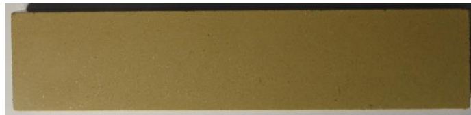
Figura 39: Corpo de prova seco com 5,0% de Resíduo Ponta de Cigarro.
