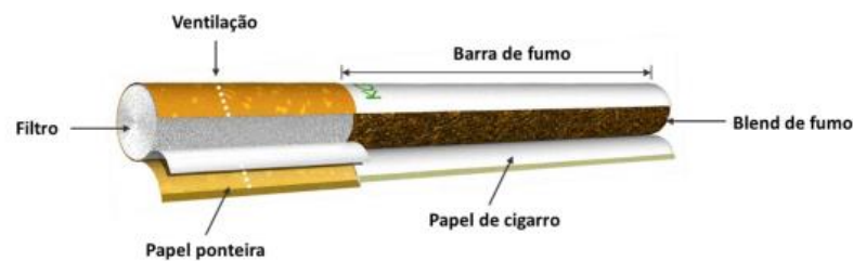
Figura 12: Esquema representativo dos principais componentes de construção do cigarro.
