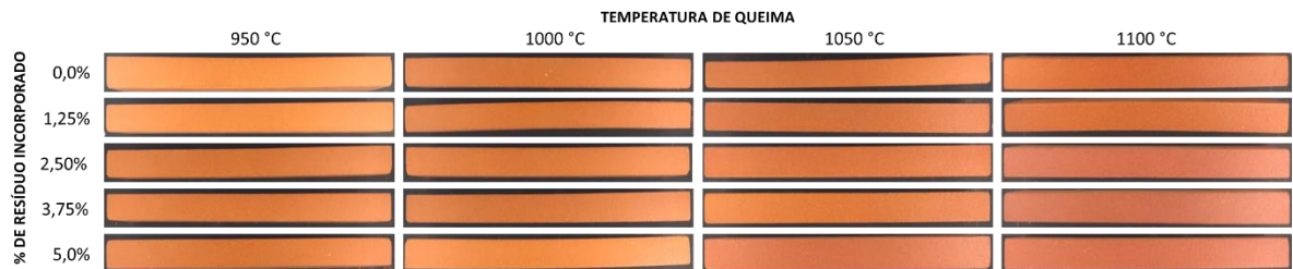
Figura 55: Fotos dos corpos de prova pós queima em função da temperatura de queima e % de resíduo incorporado com fundo preto – Vista Lateral.
