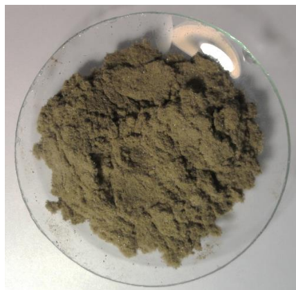
Figura 34: Amostra do resíduo ponta de cigarro após cominuição em moinho de facas.
