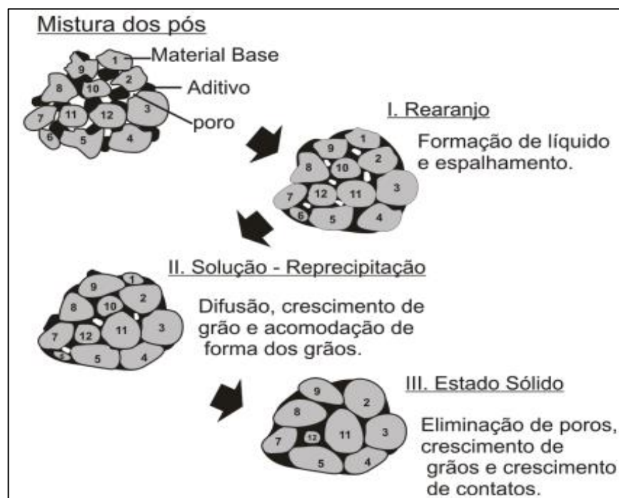
Figura 9 - Esquema dos estágios da sinterização por fase líquida envolvendo uma mistura de pós (Adaptado de GERMAN, 1985).
