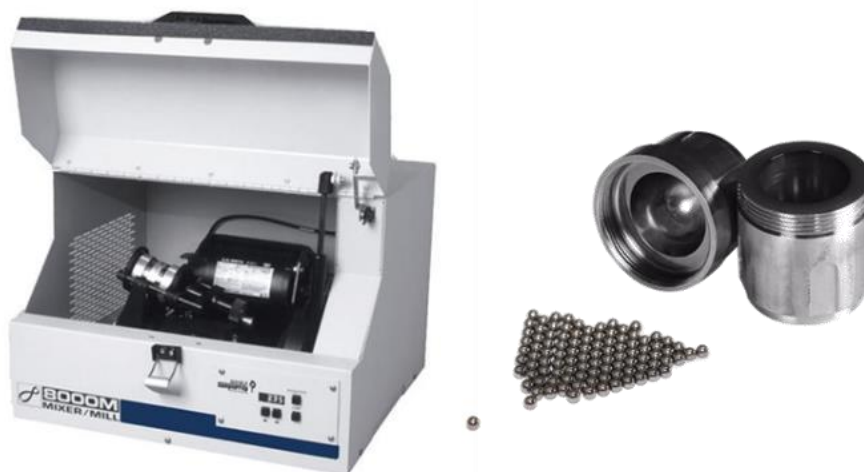
Figura 22 - Moinho de Alta energia e jarra de metal duro com esferas de metal duro (Elaboração própria).
