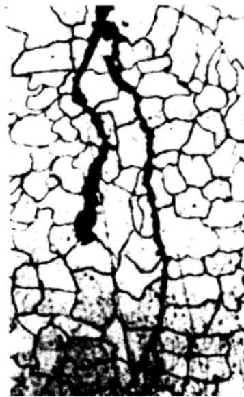
Figura 26: Corrosão intragranular em aço inoxidável submetido a ação de cloreto e temperatura.
