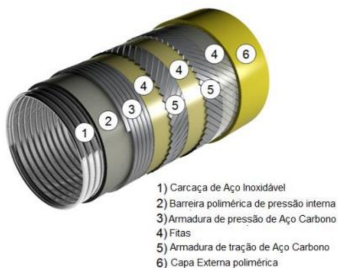
Figura 3: Composição típica de um duto flexível.
