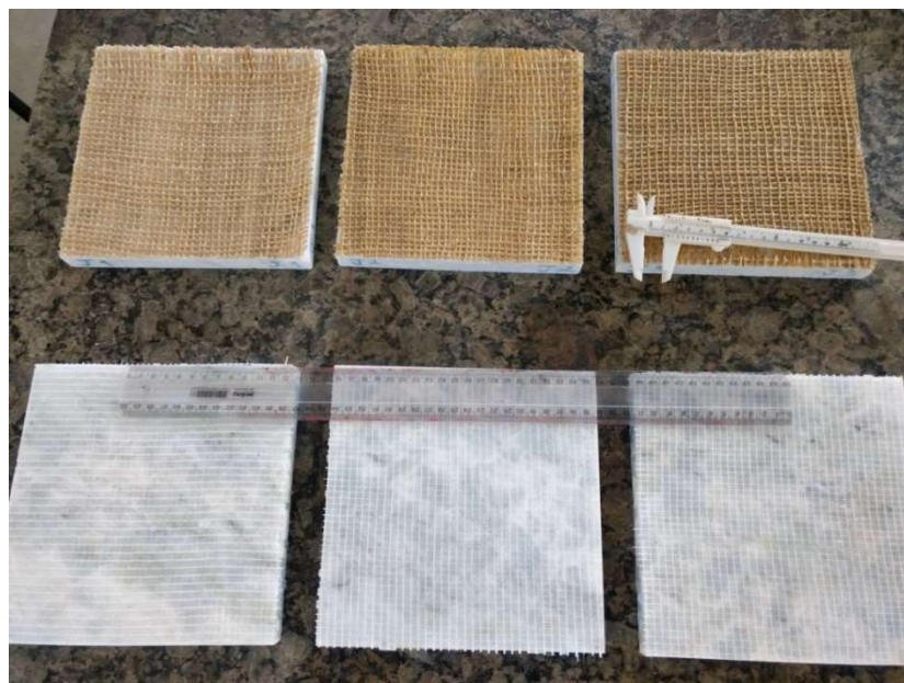
Figura 51- Rocha calcária natural laminada com fibra de bananeira (imagem superior) e com fibra de vidro (imagem inferior)
