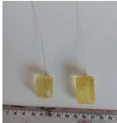
Figura 32- Fibra de bananeira inserida na matriz epoxídica DGEBA/TEPA
