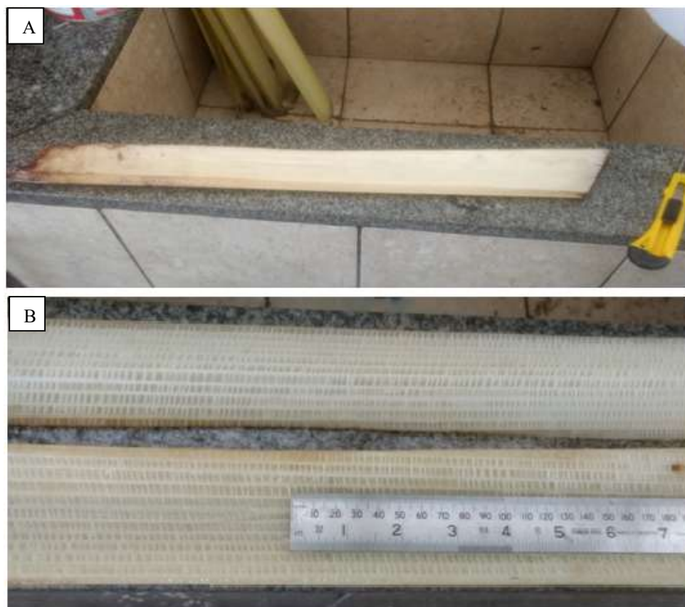
Figura 22- (A) Pseudocaule após o período de 7 dias em imersão na água; (B) Bainha externa.
