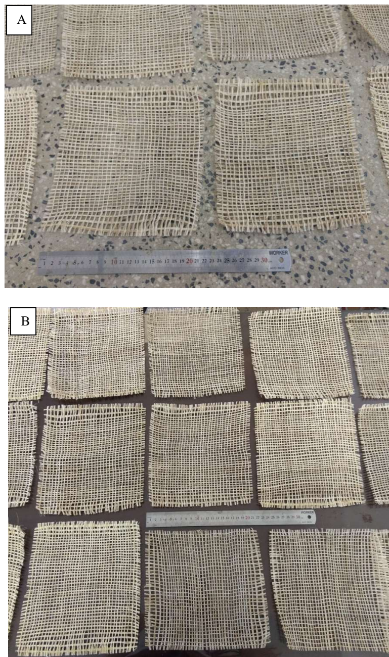
Figura 46 – (A) e (B) Rede entrecruzada de fibra de bananeira pronta para a laminação de rochas ornamentais.
