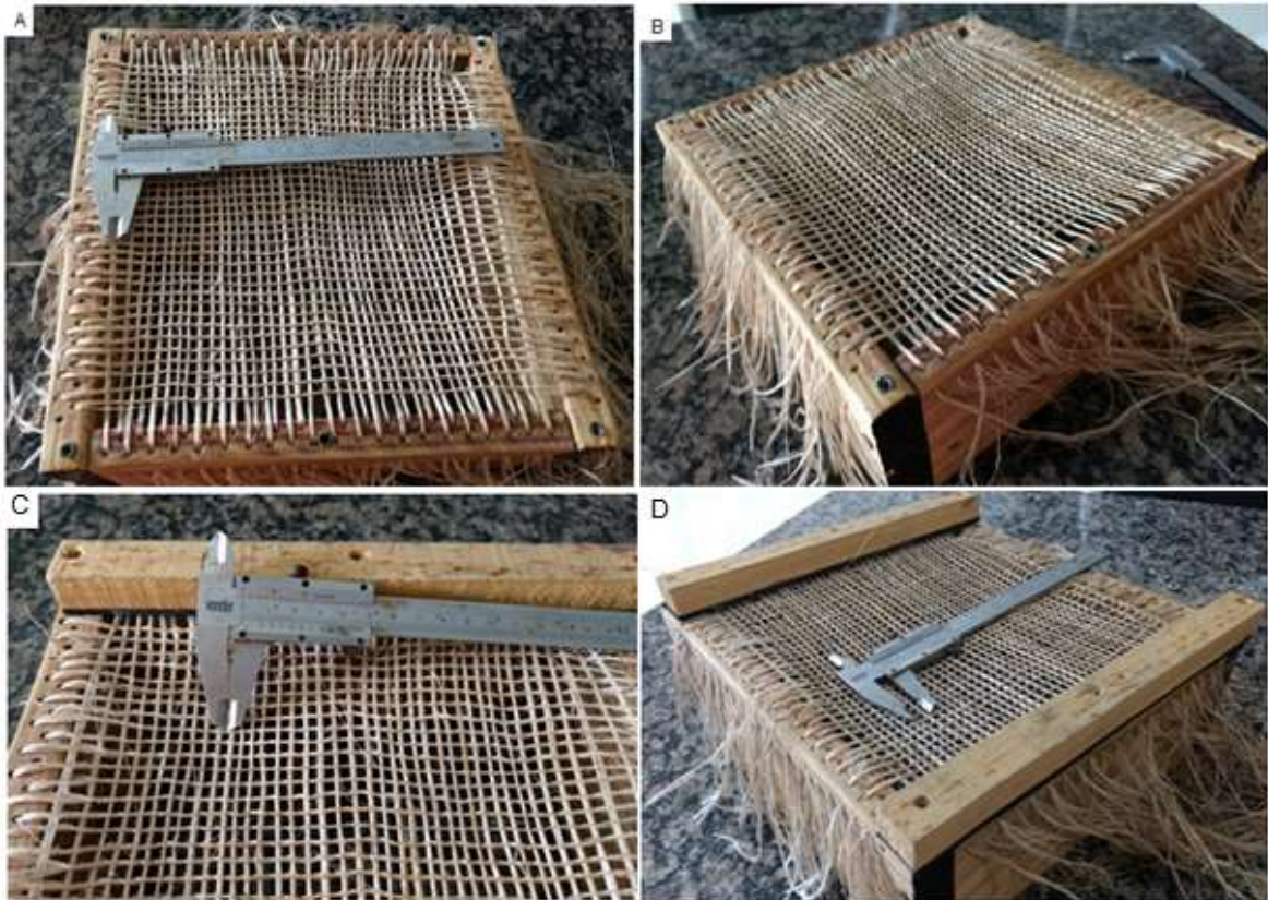
Figura 42- (A), (B), (C) e (D): Rede entrecruzada de bananeira no molde sem a parte superior de fixação.
