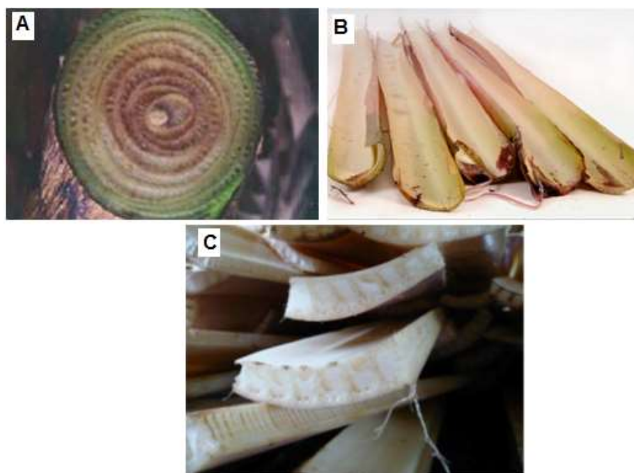
Figura 10- Pseudocaule da bananeira (A) (SILVA, 2011); Bainhas que formam o pseudocaule da bananeira (B) (DEMARCHI, 2010); (C) Detalhe da camada do pseudocaule onde se encontram as fibras (SILVA, 2008)
