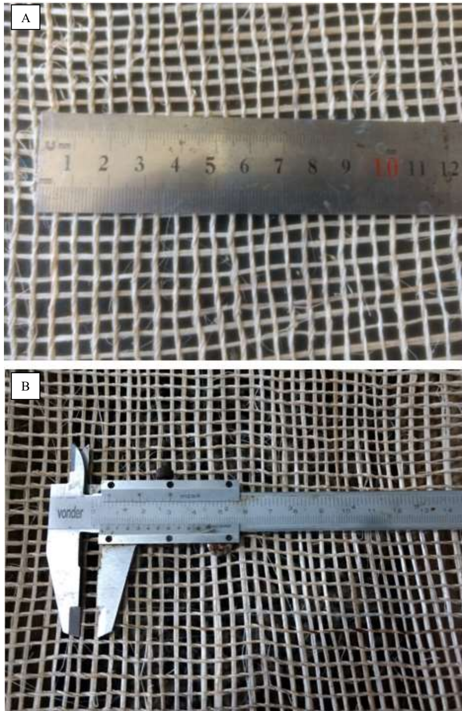
Figura 44- (A) e (B) Rede entrecruzada da malha de bananeira
