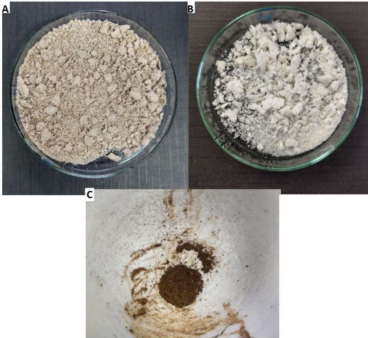
Figura 57. (A) Fibra bruta; (B) fibra branqueada; e (C) lignina extraída da fibra
