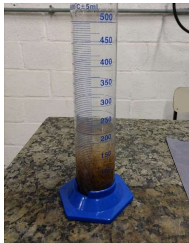
Figura 27- Deslocamento do líquido na proveta
