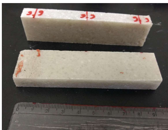
Figura 88- Rocha artificial produzida com conceitos de Silva (2016)
