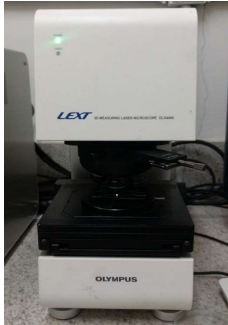
Figura 36- Microscópio confocal LEXT OLS4000-Olympus
