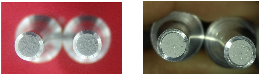
Figura 4.27: Aspectos macroscópicos das superfícies de fratura de um corpo de prova de tração entalhado após ensaio.
