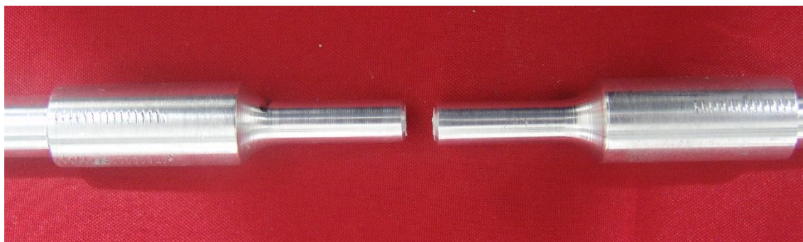
Figura 4.26: Corpo de prova entalhado após ruptura por Ensaio de Tração.
