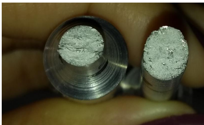
Figura 4.24: Aspecto macroscópico da fratura de um dos corpos de prova submetidos ao Ensaio de Tração.
