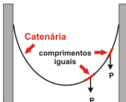
Figura 6.3: Catenária → carga uniformemente distribuída ao longo do cabo
