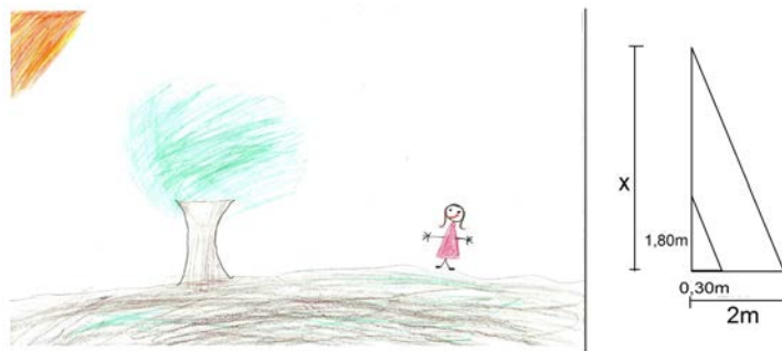
Figura 30 – Cálculo da altura de uma árvore usando medição da sombra.
