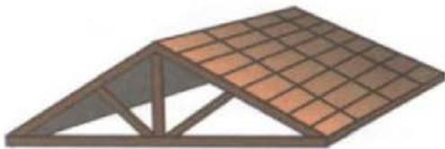
Madeiramento do telhado ou "tesoura"
