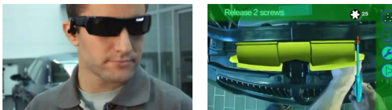
Figura 12 – RA sendo usada na manutenção de motores
