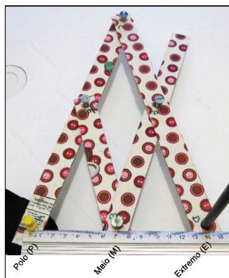
Figura 18 – Pantógrafo artesanal com escala de 1:2
