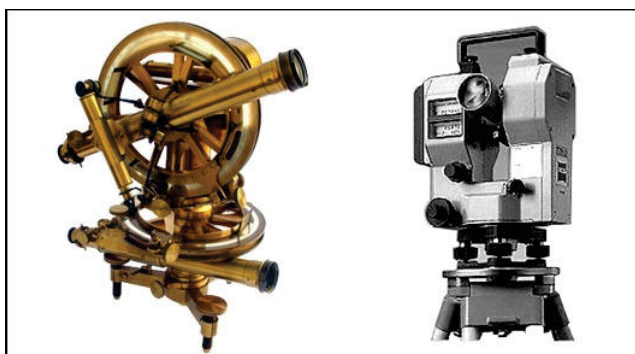
Figura 26 – À esquerda, um modelo de teodolito do século XIX e, à direita, um teodolito eletrônico
