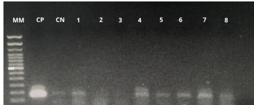
Figura 15: Gel de agarose 1% resultante da eletroforese de produtos de amplificação de PCR para gene seb . MM: marcador de peso molecular; CP: controle positivo; CN: controle negativo; poços: 1, 4, 6 e 7: amostras 2, 45, 68 e 70 positivos.
