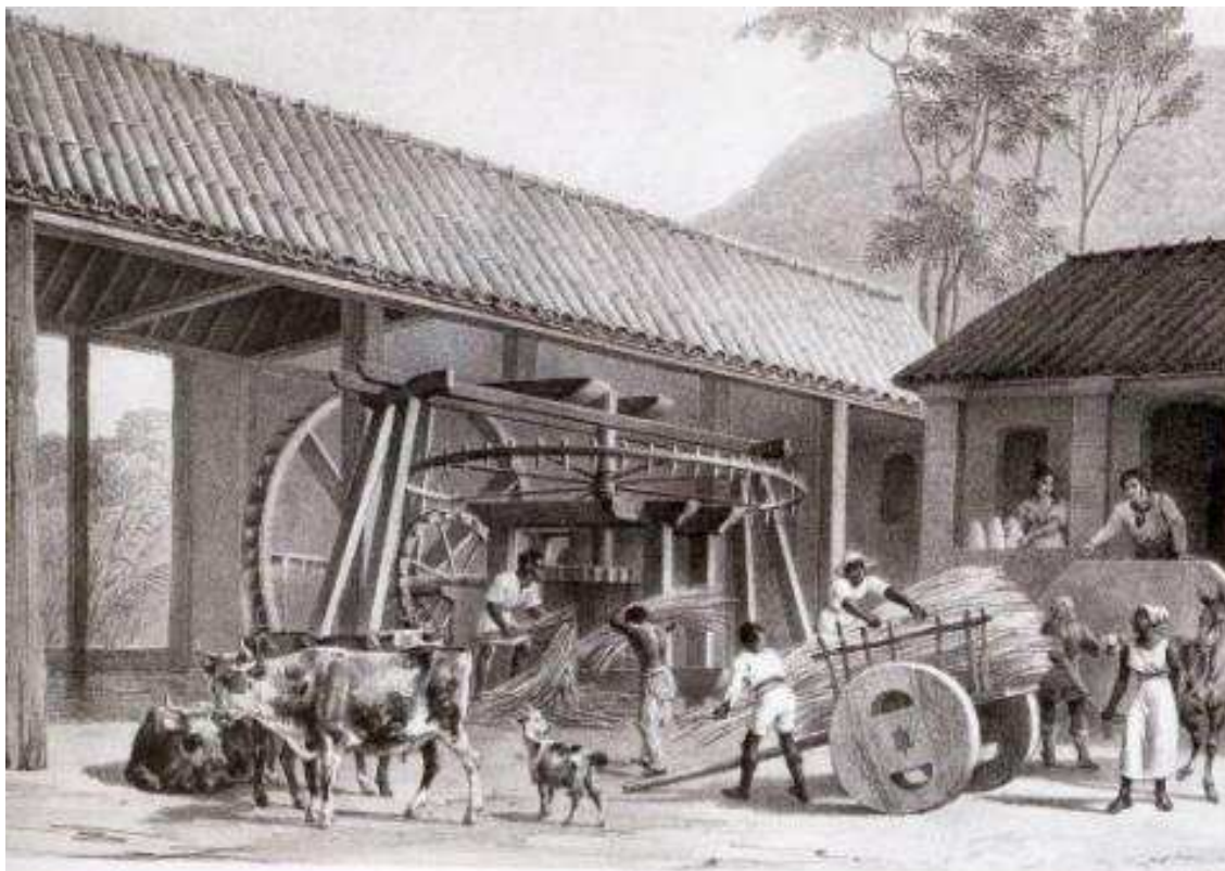
Figura 1 - Engenhocas de tração humana, animal ou roda d'água (meados do século XVII a meados do XIX),
