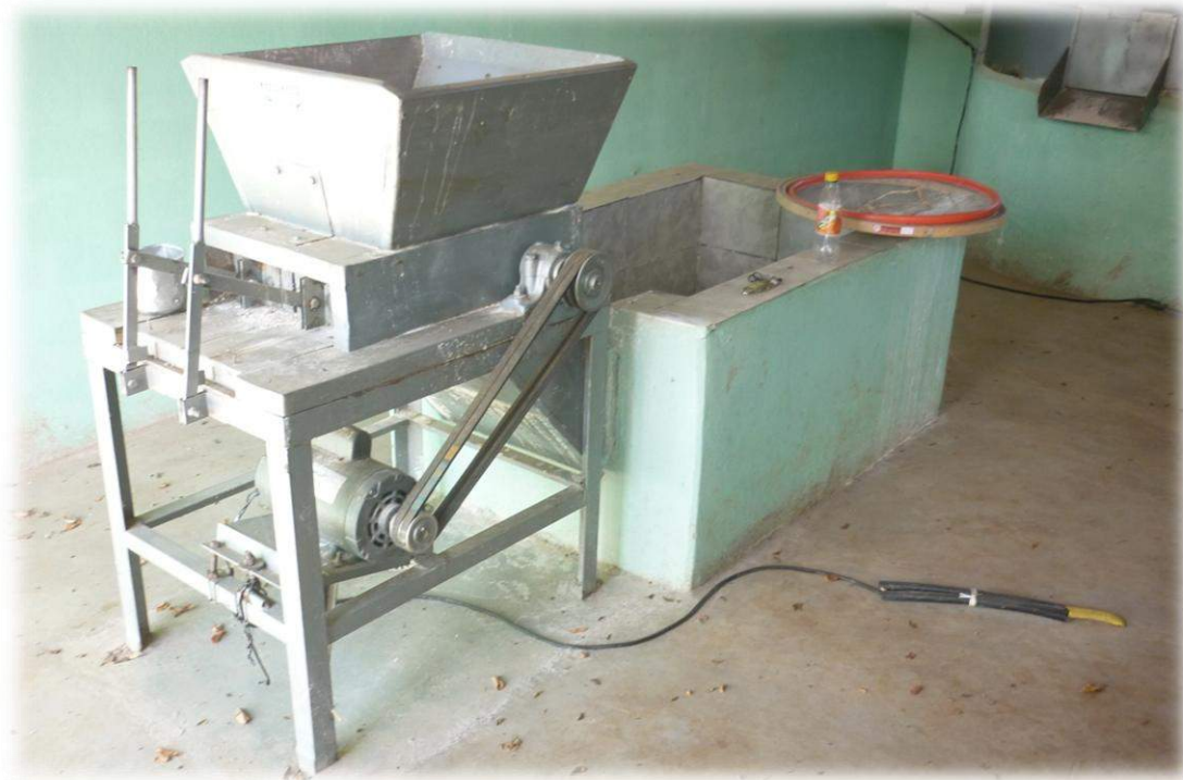
Figura 40: Máquina de triturar mandioca .
