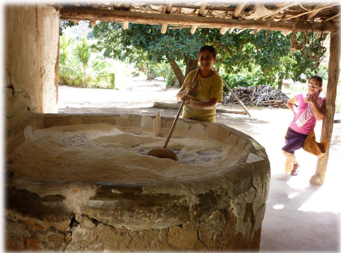
Figura 46: Forno de torrar farinha em anexo da farinheira em Pedra Alta.
