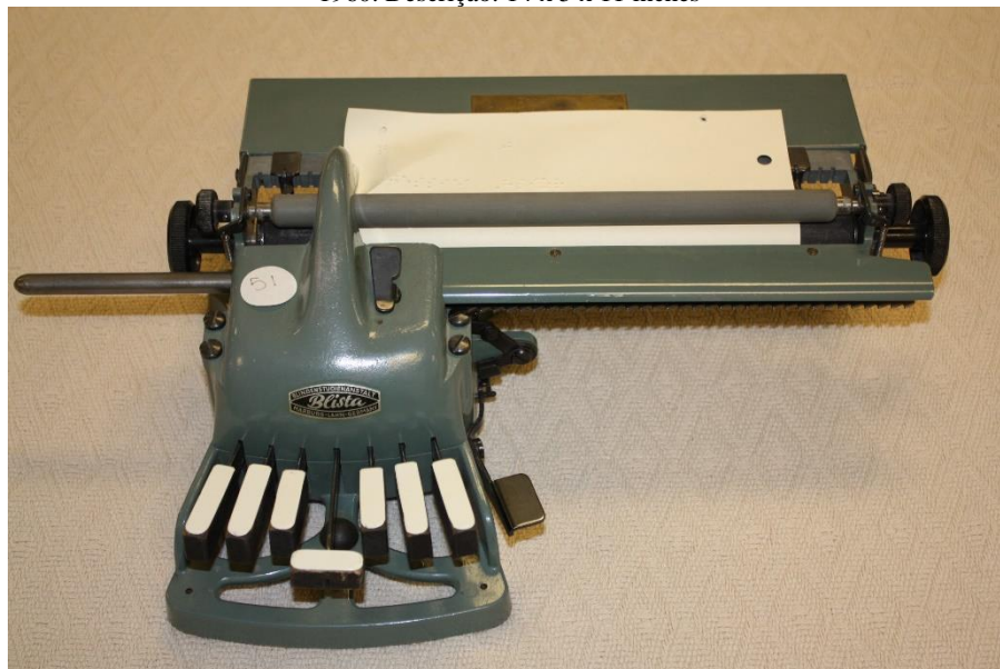
Figura 1- - Imagem ilustrativa de máquina de escrever em braile Blista Braillewriter. Fabricada na Dinamarca na década de 1960. Descrição: 14 x 5 x 11 inches
