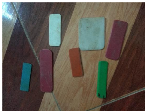
Imagem 66: Tabuletas utilizadas como diapasão para tecer as malhas das redes
