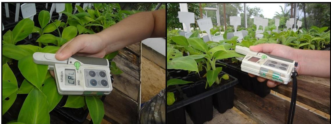
Figura 16A: Determinação da Intensidade de Verde com SPAD-502.
