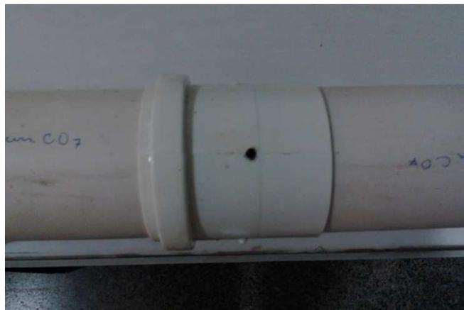
Figura 8. Peça central (conector) do aparato para avaliar a dispersão de nematoides no solo, com detalhe do orifício para semente dos juvenis de nematoides entomopatogênicos.
