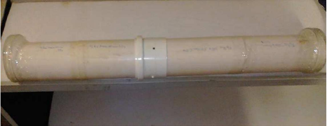
Figura 7. Aparato desenvolvido para a avaliação da dispersão de nematoides no solo, composto por canos de PVC e Placas de Petri contendo colônias de fungos nas extremidades opostas.
