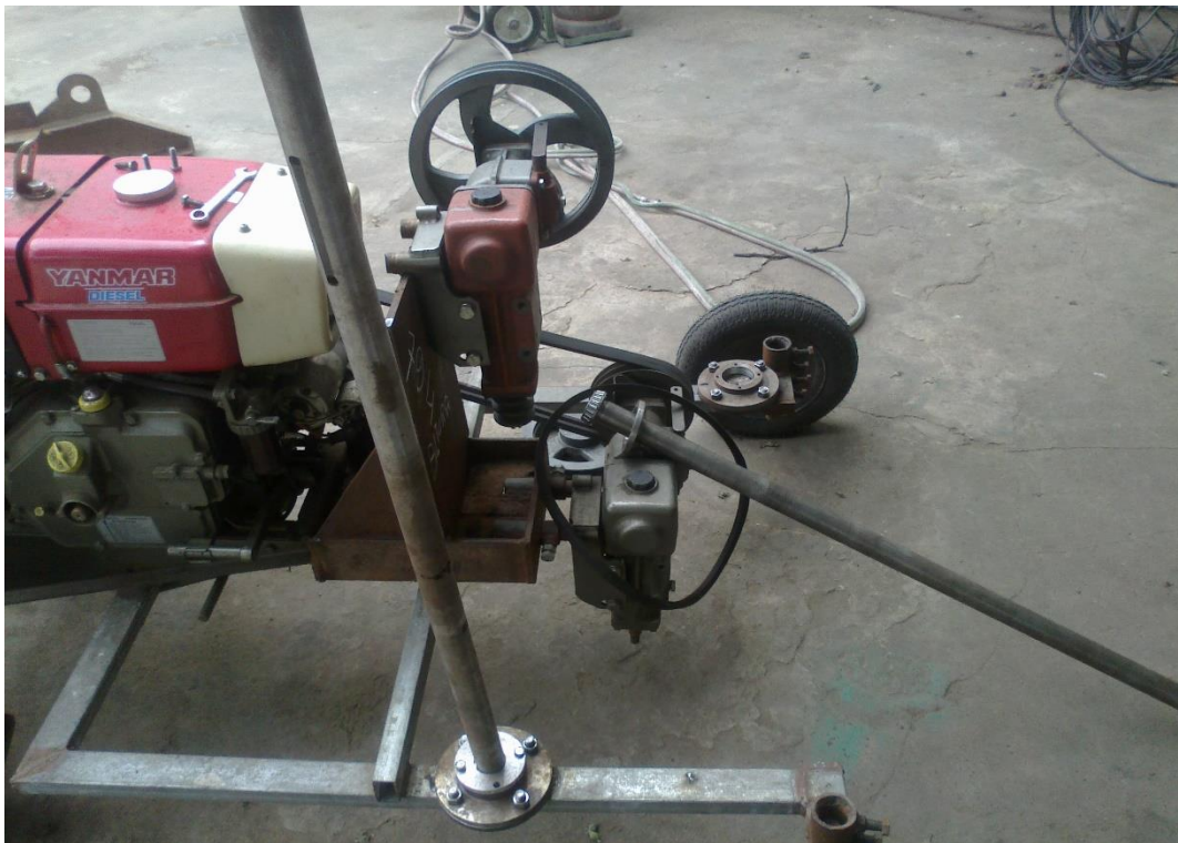
Figura 11. Montagem do chassi, posicionamento das rodas e caixa de transmissão do sistema de corte.
