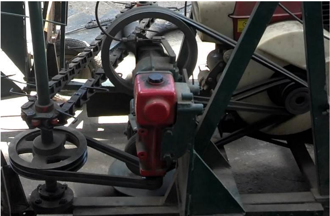
Figura 14. Montagem do sistema de transmissão com polias e correias.
