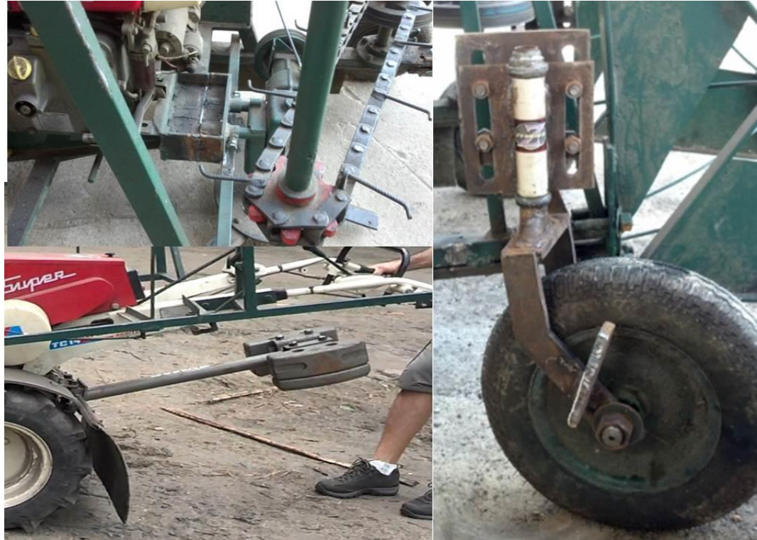
Figura 23. Modificações na redução do sistema de corte, alteração na estrutura do sistema de rodagem, e posicionamento do lastro.
