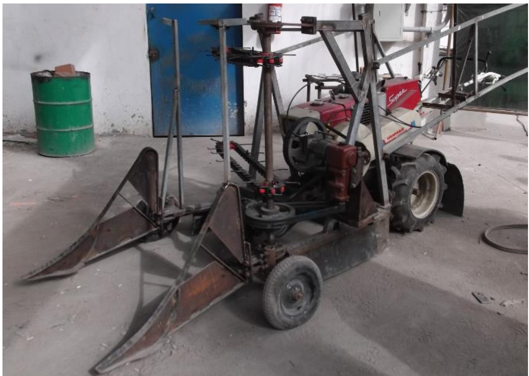
Figura 15. Montagem das engrenagens e correntes transportadoras.
