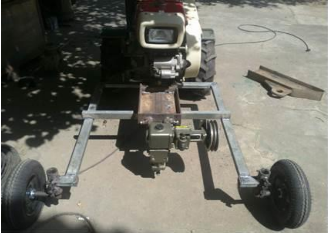
Figura 11. Montagem do chassi, posicionamento das rodas e caixa de transmissão do sistema de corte.
