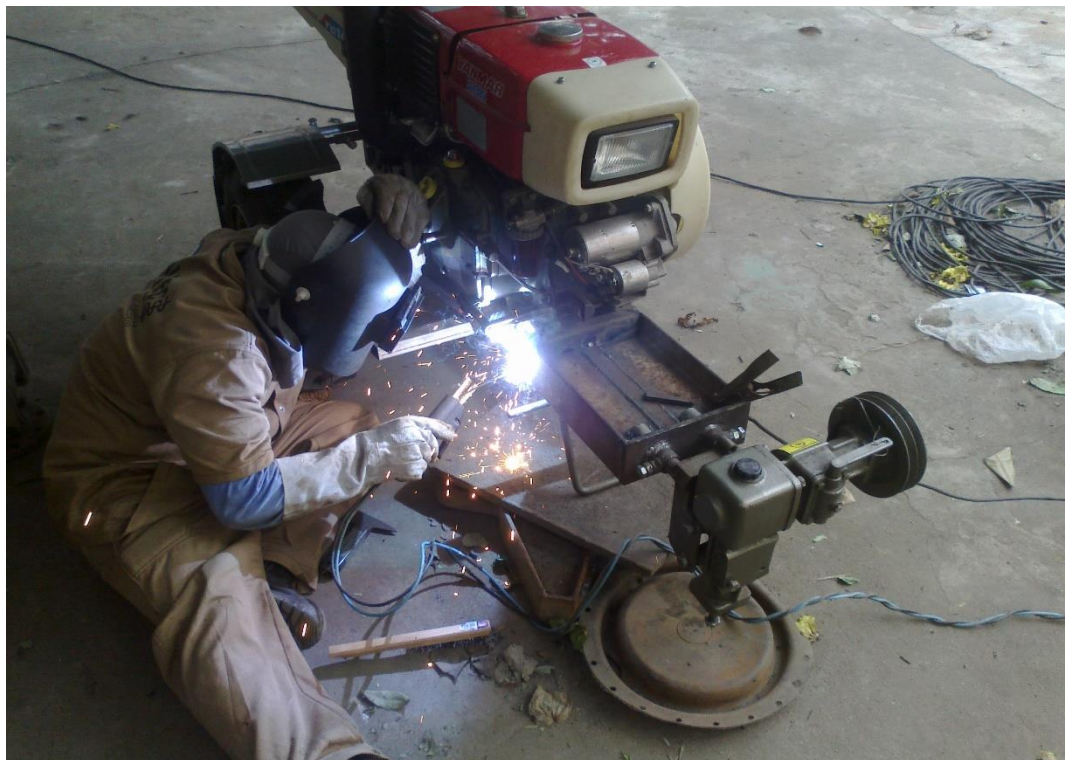
Figura 10. Acoplamento da máquina ao microtrator para a fabricação do chassi.
