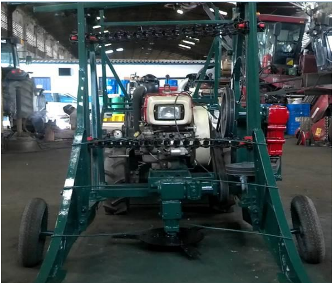
Figura 18. Vista frontal da máquina na fase final de montagem.
