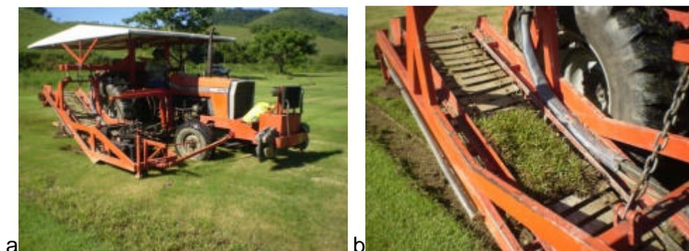
Figura 4. a- Máquina de corte do tapete REMAQ<sup>®</sup>, b- Corte dos tapetes para avaliação aos 380 DAP- Cachoeiras de Macacu- RJ, 2010.
