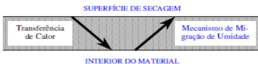
Figura 2. Diagrama da transferência simultânea de calor e massa, envolvendo a migração de umidade do interior do material para a sua superfície, no processo de secagem (PARK et al. , 2007).
