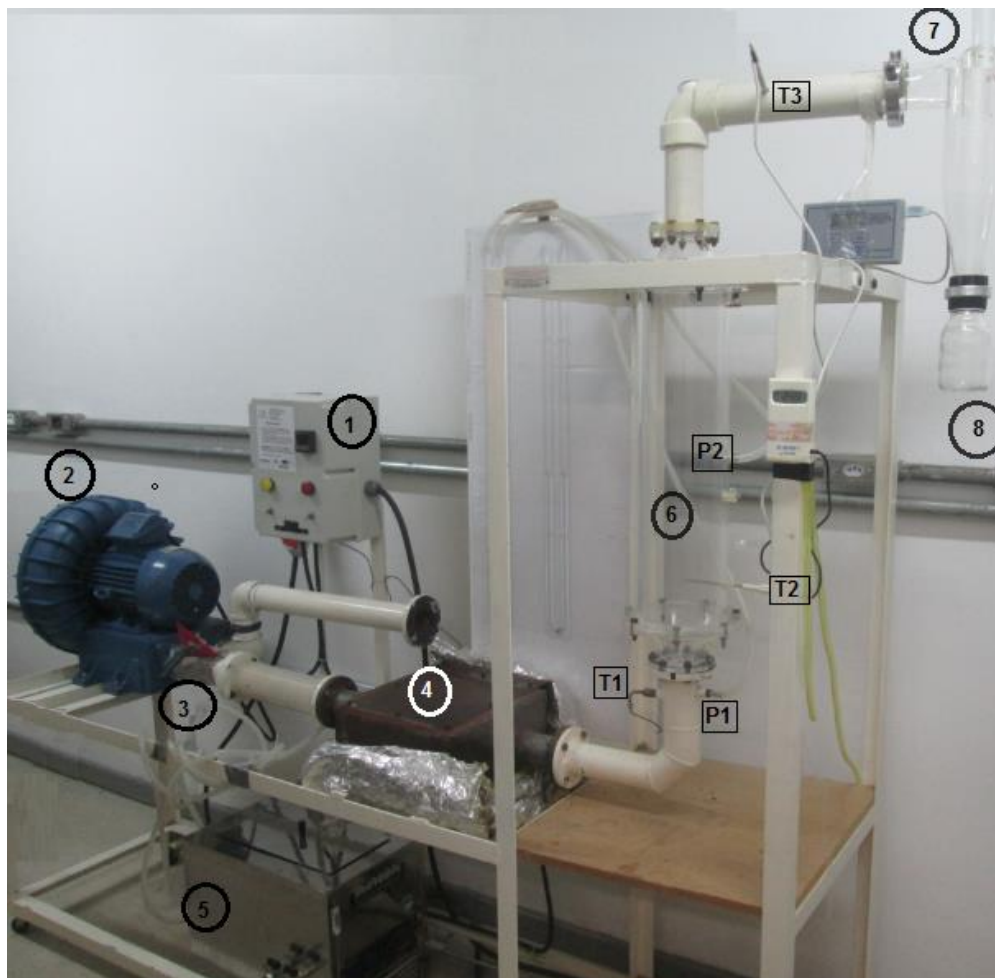
Figura 6. Secador de leito de jorro. (1) acionamento do aparelho e controle da temperatura, (2) compressor radial, (3) válvula globo, (4) aquecedor, (5) resfriador, (6) leito de jorro com os termopares [T1 = temperatura do ar de entrada; T2 = Temperatura do leito de partículas; T3 = Temperatura do ar de saída] e as tomadas de pressão ligadas ao manômetro de água [P1 e P2], (7) ciclone e (8) coletor de pó.
