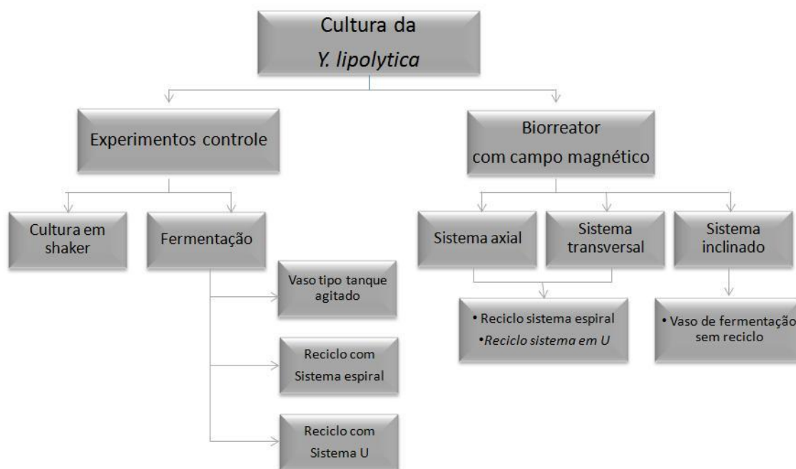
Figura 13. Estratégia de cultura de Y. lipolytica em diferentes configurações de sistemas sob o efeito ou não do campo magnético.
