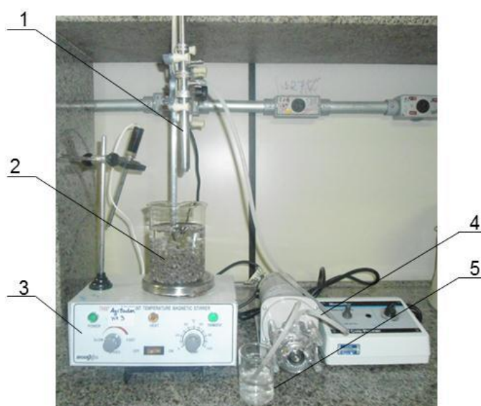
Figura 6. Esquema geral do sistema usado para preparar os suportes de alginato de cálcio com e sem magnetita e os de quitosana. Símbolos: 1- bico de atomização; 2 - Recipiente contendo a solução cloreto de cálcio 0,1 M; 3- agitador magnético; 4 - bomba peristáltica; 5-solução de alginato de cálcio ou quitosana.
