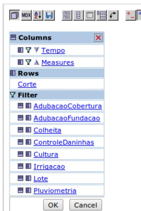
Figura 25 - Tela do “Olap Navigator”, que permite a seleção das dimensões, métricas e sua disposição sobre os eixos de visualização, além da definição de filtros sobre as dimensões
