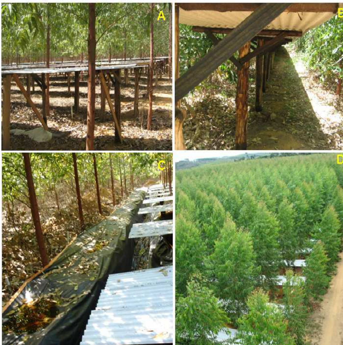
Figura 2 – (A) e (B) Suporte das telhas de amianto; (C) Canais impermeabilizados por lonas; (D) Vista de cima do experimento.
