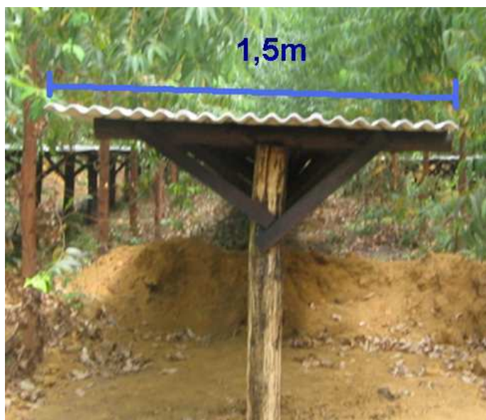
Figura 1 – Estruturas de suporte das telhas de fibrocimento ondulado (Eternit®) que foram instaladas na entrelinha do plantio a fim de reduzir a precipitação pluviométrica na área com restrição hídrica.
