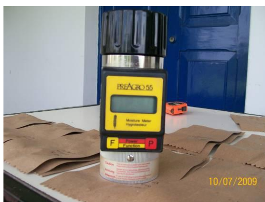
Figura 9: Medidor de umidade
