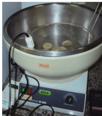
Figura 8. Pré-tratamento de fatias de banana com solução de 0,5 % de ácido ascórbico e 1 % de ácido cítrico a 70 °C por 90 s.
