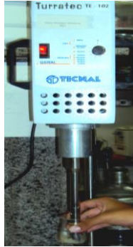
Figura 9. Agitação da amostra diluída de banana para leitura no refratômetro.
