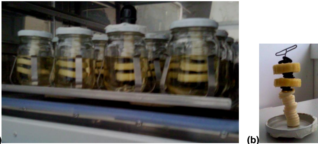
Figura 13. Frascos contendo amostras de banana imersas em solução de sacarose, posicionados na incubadora (a) e conjunto tampa com haste metálica e separadores para fixação das fatias (b).
