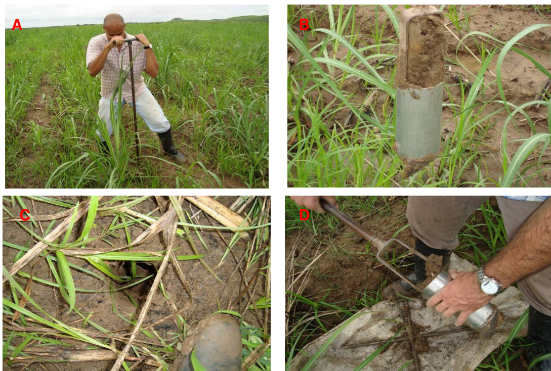
Figura 2: Amostragem de solo em canal da Usina Sapucaia S/A, onde foi montado o experimento. A. Amostragem de solo a 25 cm. B. Trado com amostra de solo coletada. C. Furo do solo, após coleta. D. Retirada de amostra do solo do trado.
