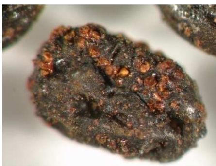
Figura 25: Fotografia digital de uma partícula de alginato com ferro 1% (p/v) gelificada por 2 horas em solução de cloreto de cálcio 0,1 molar.
