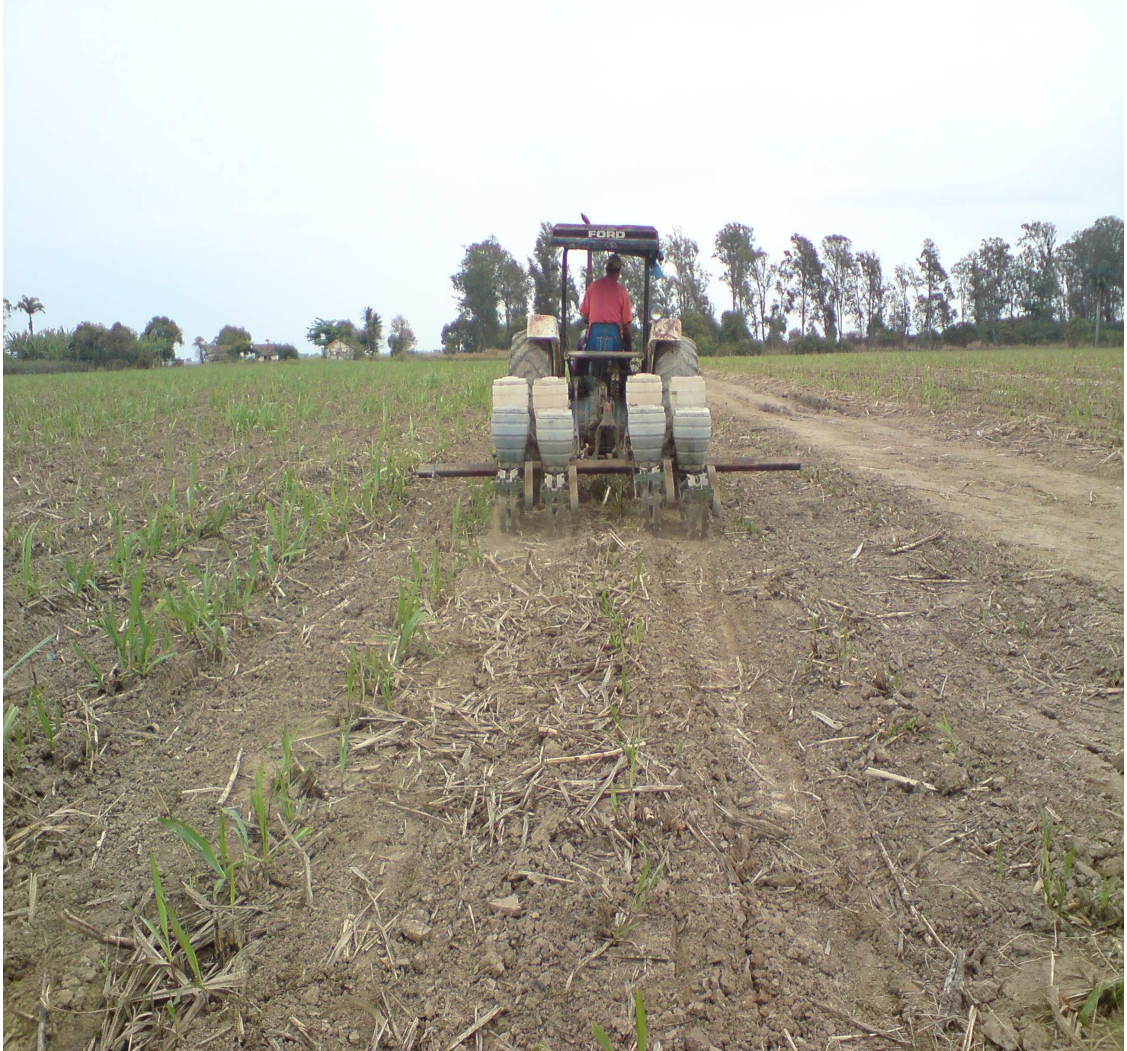
Figura 2. Detalhe da semeadora para o plantio da C. juncea nas entrelinhas da cana-de-açúcar.
