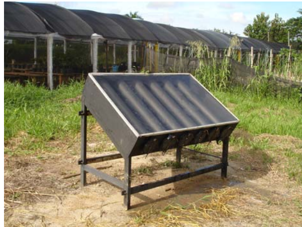
Figura 6. Equipamento utilizado para solarização do substrato usado no experimento.
