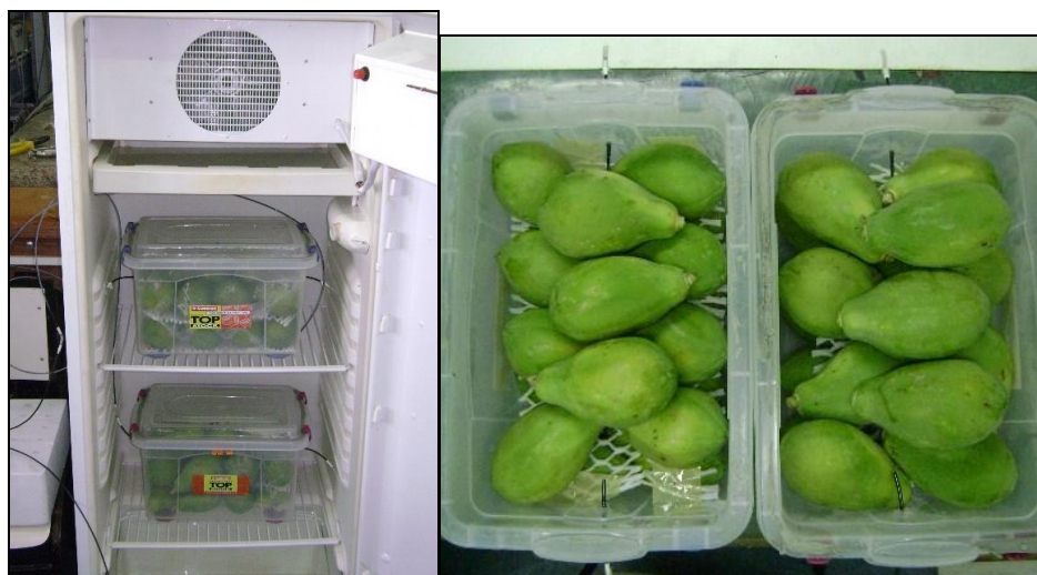
Figura 6 – Montagem experimental usada para a submissão dos frutos à exposição de etileno exógeno.
