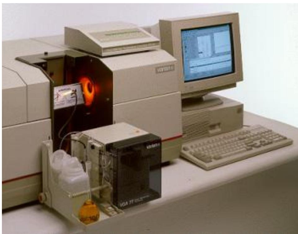
Figura 13 – Espectrofotômetro de absorção atômica com gerador de hidretos.
