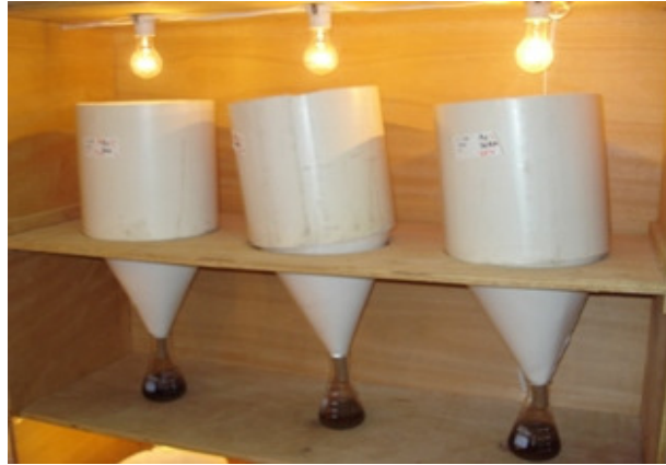
Figura 3. Bateria de extratores Berlese-Tüllgren.
