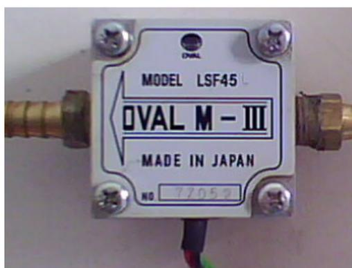
**Figura 3.** Sensor volumétrico para determinação de fluxo de combustível.
