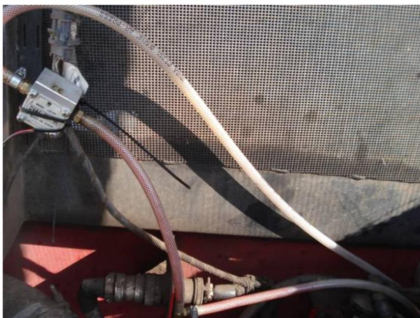
**Figura 6.** Sensor de fluxo de combustível montado na colhedora A4000.
