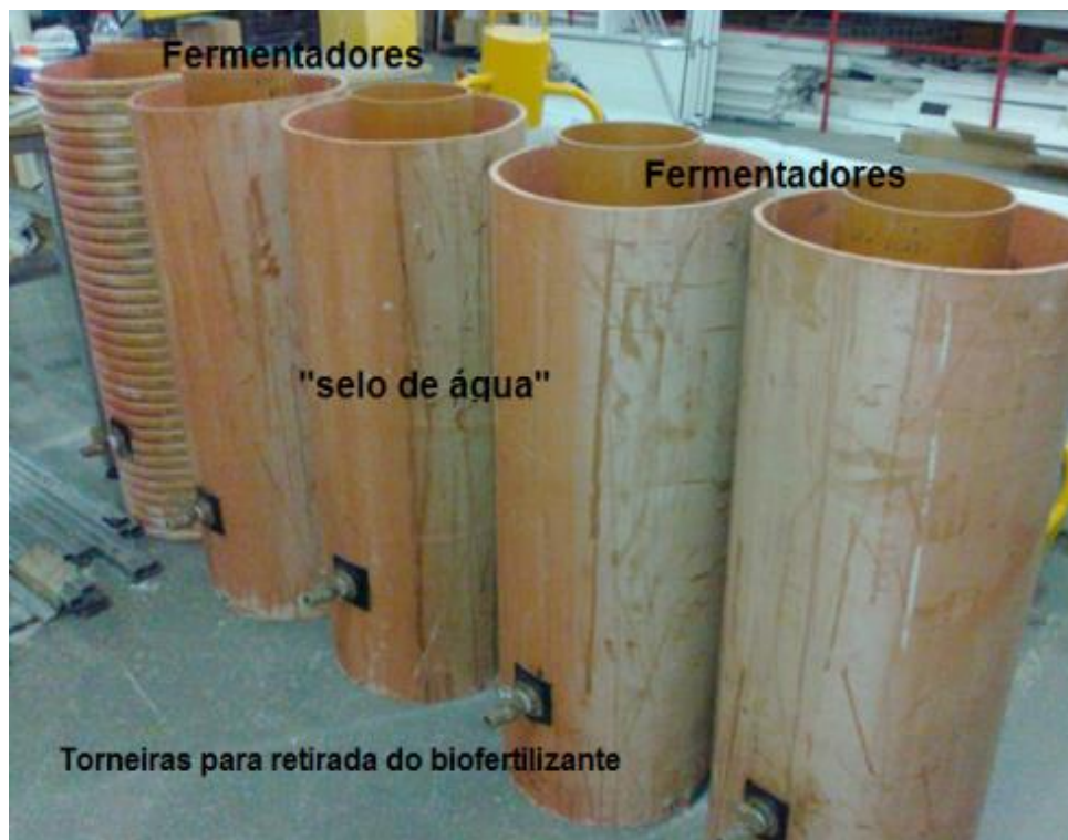
Figura 14 – Montagem do fermentador conectado ao selo de água.
