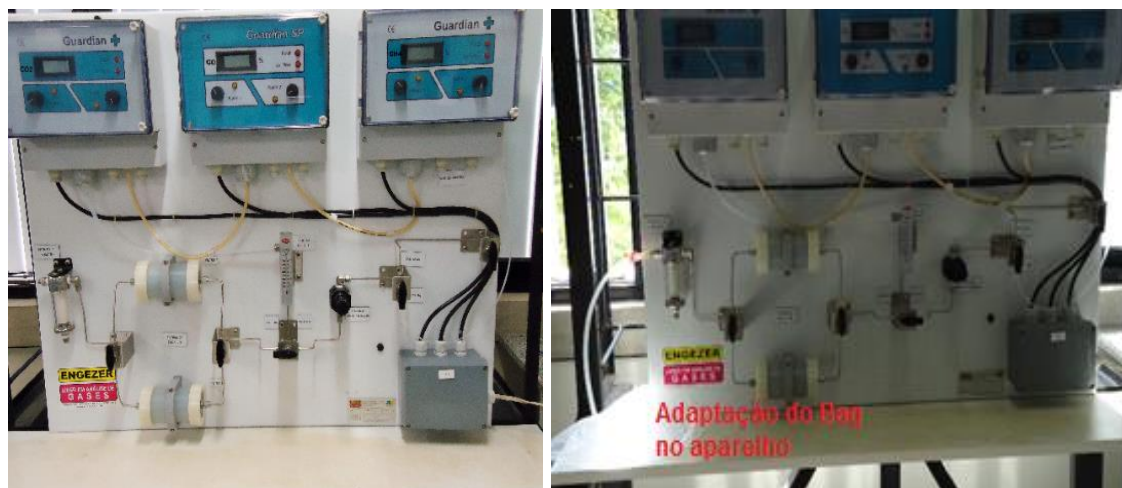
Figura 24 – Aparelho medidor de gás Engezer, aparecendo uma bag acoplada ao aparelho.
