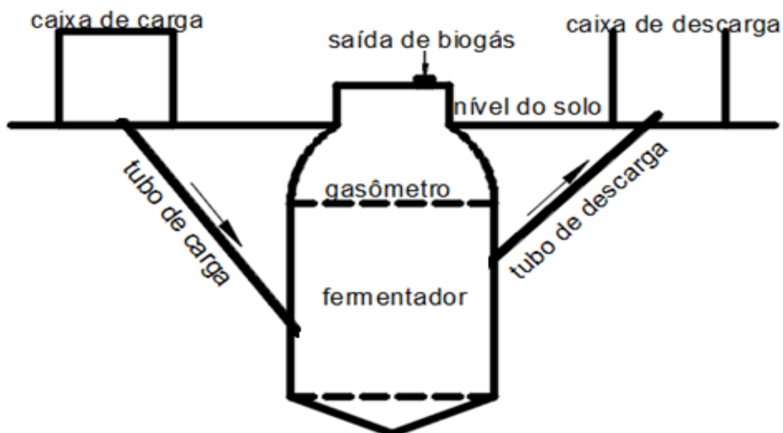
Figura 4 – Vista frontal de um biodigestor modelo chinês com os seus componentes. Fonte: Adaptado de França Junior (2008).
