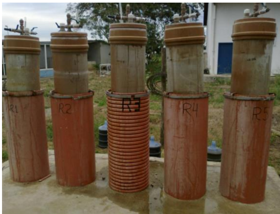
Figura 12 - Conjunto de biodigestores modelo indiano tipo batelada (R1, R2, R3, R4 e R5), instalados na base de concreto, em operação. UENF, Campos dos Goytacazes, RJ.
