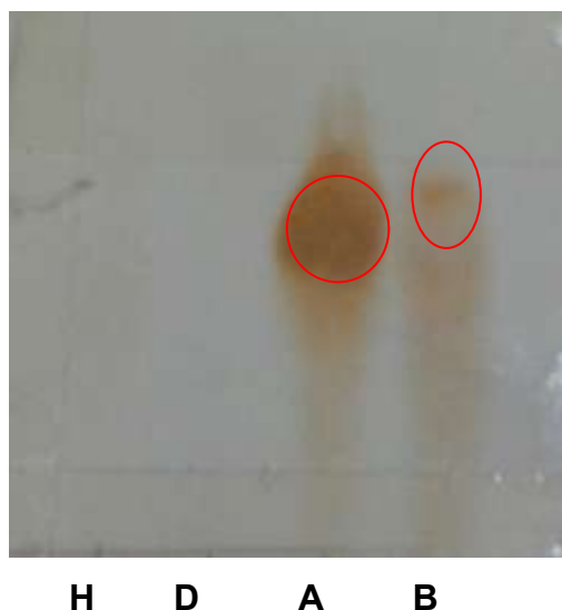
Figura 22: Cromatoplaça das frações Hexânica (H), Diclorometano (D), Acetato de etila (A) e Butanólica (B) realizado em CCD. Fase móvel: butanol:acetato:água (8:1:1) e revelado com sulfato cérico.
