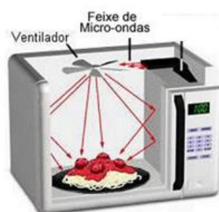
Figura 3 - Interação entre as micro-ondas e o material dentro da cavidade do forno micro-ondas. Fonte: brasilescola.com
