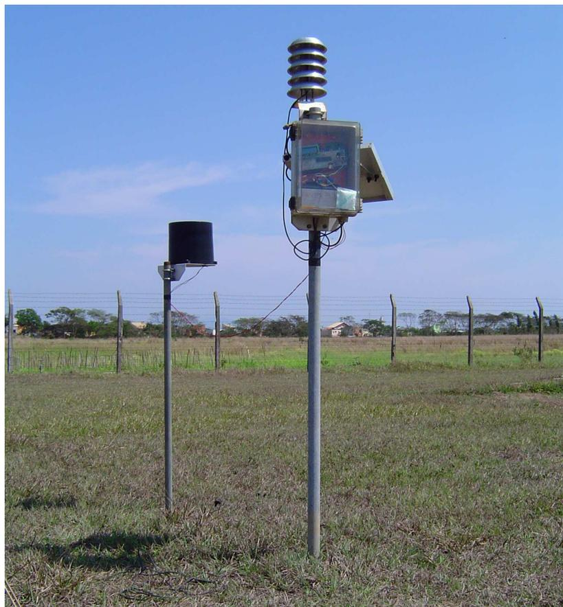
Figura 12 – Protótipo instalado em campo, com abrigo de sensor de temperatura, painel coletor de energia solar, caixa hermeticamente fechada com sistema eletrônico, pluviômetro eletrônico e as hastes de tubo galvanizado.
