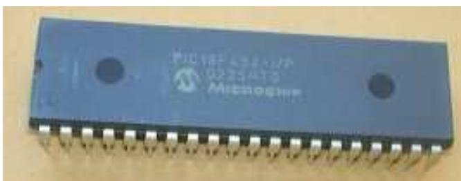
Figura 13 – Microcontrolador PIC-18F452 da marca MICROCHIP-TM.
