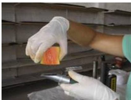
Figura 10 – Determinação da concentração dos sólidos solúveis da polpa dos frutos de mamoeiro híbrido UC-01, utilizando um refratômetro manual (Sama – MT – 032).
