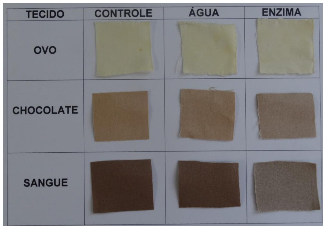
Figura 13: Remoção de manchas de tecidos sujos com ovo, chocolate e sangue utilizando solução enzimática de Bacillus sp. SMIA- 2 a 50°C por 60 minutos e 150 rpm.
