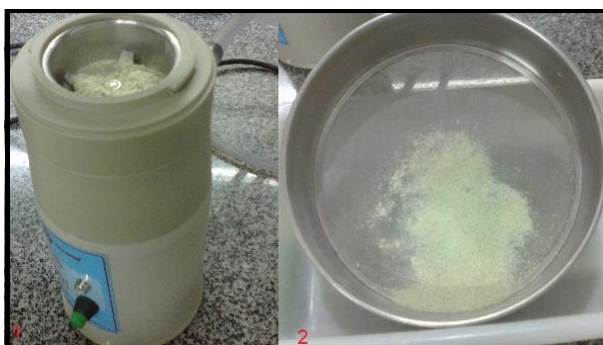
Figura 9. Processo de trituração da farinha do albedo. Legenda: (1) moinho analítico (Marca quimis); (2) peneira gramatura de 0,297 mm.
