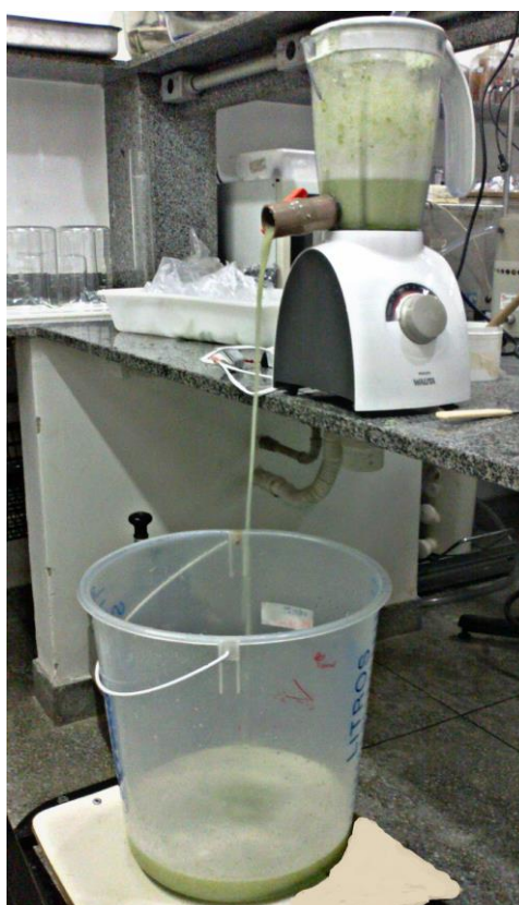
Figura 5. Sistema de homogeneização da casca bruta constituído de 1 tanque de água destilada que alimenta o aparelho liquidificador contendo um cilindro de tela com o dilacerador na base do copo e tubulação de descarga da água de arraste das partículas da casca do maracujá. O liquidificador possui dispositivo de controle de velocidade de rotação das lâminas dilaceradoras
