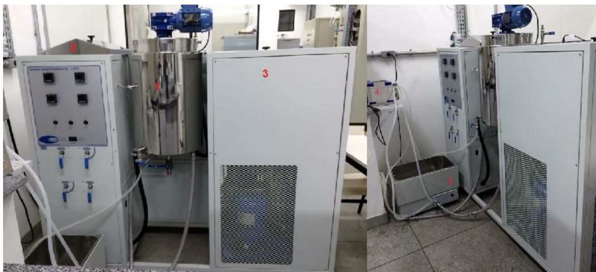
Figura 6: Tanque de tratamento térmico (SOLAB, SL 130/42). Legenda: (1) cuba de tratamento térmico; (2) tanque de aquecimento; (3) tanque de resfriamento; (4) bomba peristáltica para circular a água de suspensão do material dentro da cuba e (5) Tanque para drenagem dos fluidos contidos na camisa da Cuba.
