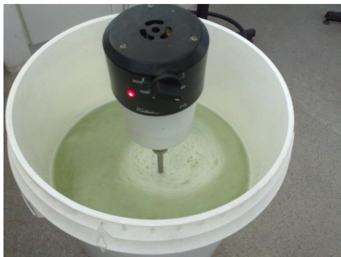
Figura 7: Processo de agitação da casca bruta do maracujá durante o tratamento químico.
