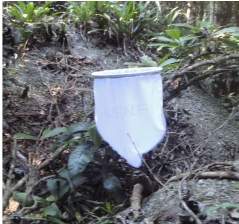
Figura 4- Coletor de serrapilheira instalado na área amostral, confeccionado com um aro metálico acoplado a um cone coletor de pano.
