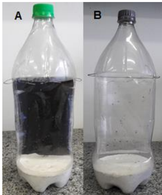
Figura 7: A- Armadilha PET com pano preto envolvido por um filme adesivo, B- Somente com o filme adesivo pendurado no arame.
