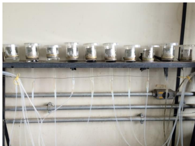
Figura 3. Método do funil de placa porosa para obtenção da curva de retenção de água das diferentes proporções de mistura de lodo de esgoto com o substrato comercial ou a fibra de coco para composição de substrato para produção de mudas de vinhático ( Plathymentia reticulata Benth).
