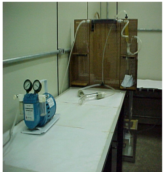
Figura 2. Esquema do tubo do olfatômetro de duas vias, modelo em "Y" (Esq.). Foto do dispositivo olfatométrico (Dir.).
